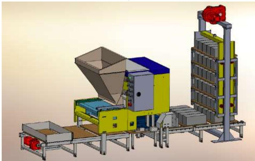
Ligne de production comprenant une machine semi-automatique de type TB1000, un magasin à planches d'une capacité de 5 planches, d'un convoyeur motorisé permettant d'éjecter les planches chargées de la machine et d'amener une planche vide sous le moule et d'un ascenseur motorisé de 5 niveaux au pas de 350 mm
