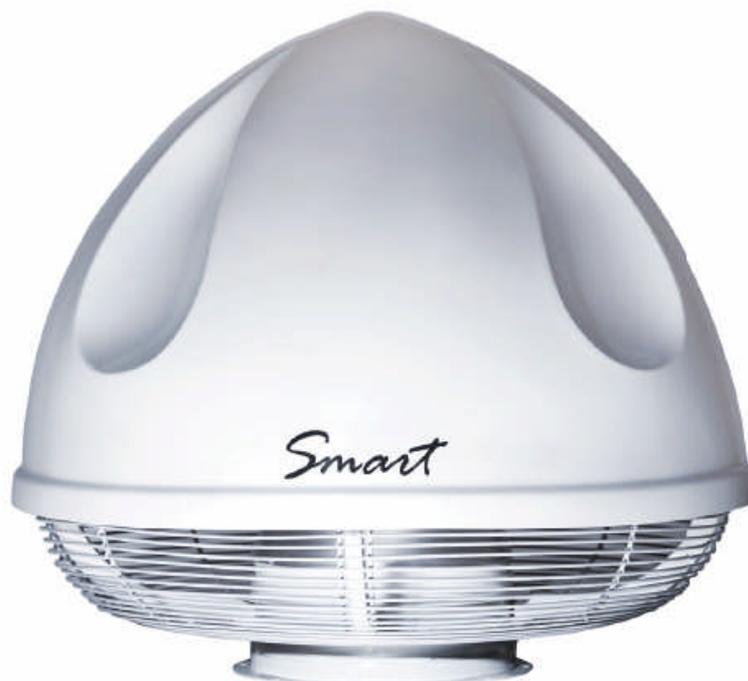
**Application** : Les ventilateurs de toiture modèle SMART ont été spécifiquement conçus pour les applications de ventilation générale des bâtiments industriels ou d'habitation. Ils sont prévus pour le transport d'air sec jusqu'à une température de 60° C, avec un taux de poussières ne dépassant pas 0.3 g/m<sup>3</sup>. Ils ne sont pas prévus pour des atmosphères agressives, visqueuses ou polluées avec des substances provoquant un éventuel risque explosif.
